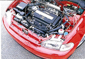
▲シビック・フェリオSIRのエンジンルーム。1.6L DOHC・VTECで出力/トルクは170ps/16.0kgm。
