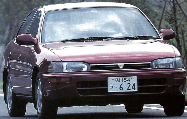
▼スプリンターGT。操安性はロールを抑え、応答性をよくしたセッティングだ。
