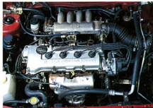
▲パルサーX1Rのコックピットとエンジンルーム。エンジンルームにはGA16DE型パワーユニットがマウントされる。DOHC・16バルブで出力/トルクは110ps/15.0kgm。
