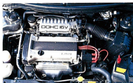
▲ジェミニのエンジンルーム。1.6L DOHCで出力/トルクは140ps/14.5kgm。
