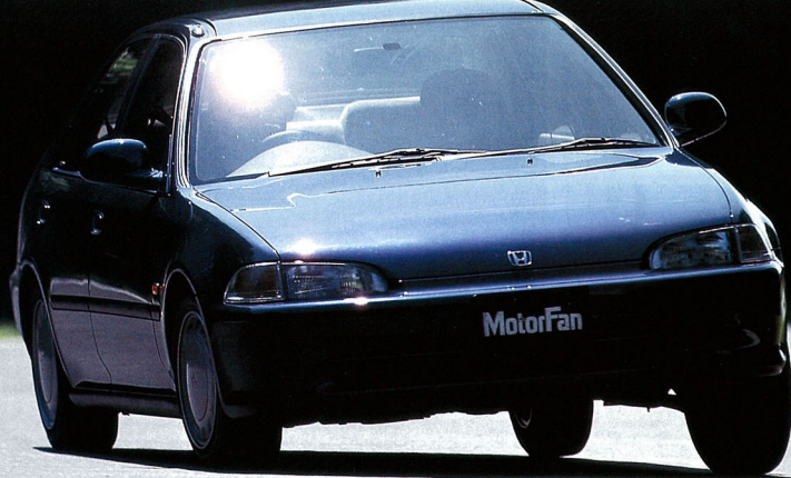
▲シビック・フェリオSiR。フロントのロールセンターを下げ、リヤをしっかりと位置せしめ、しなやかな前めりのロールを利用してコーナーをクリアしていく。
