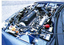
▲◀シビックVTiのコックピットとエンジンルーム。SRSエアバックはメーカーオプション。D15B型エンジンは可変バルブタイミング・リフト機構をもつSOHC・16バルブ。
