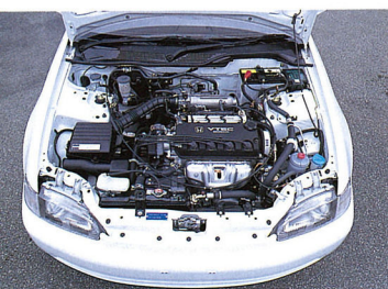
▲1500VTIに搭載されるD15B型エンジン。SOHC・VTECで最高出力130ps/6800rpm、最大トルク14.1kgm/5200rpmを発生する。
