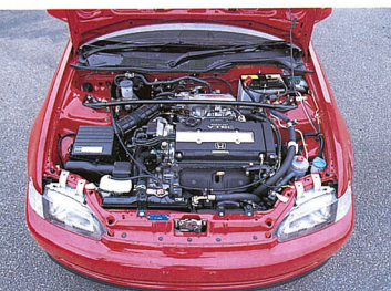
▲1600SiRのパワーユニットはB16A型。DOHC・VTECで最高出力170ps/7800rpm、最大トルク16.0kgm/7300rpmを発生する。
