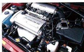
▲スプリンタのエンジンルーム。1.6L DOHCで出力/トルクは160ps/16.5kgm。
